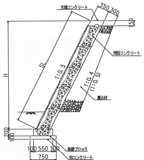
※現場打基礎等や状況に応じて、ズレ止筋(D16×400 etc750)を使用します。
