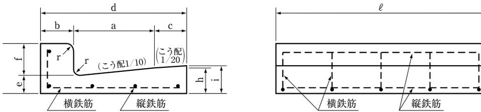
コンクリート及び鉄筋コンクリートL形
